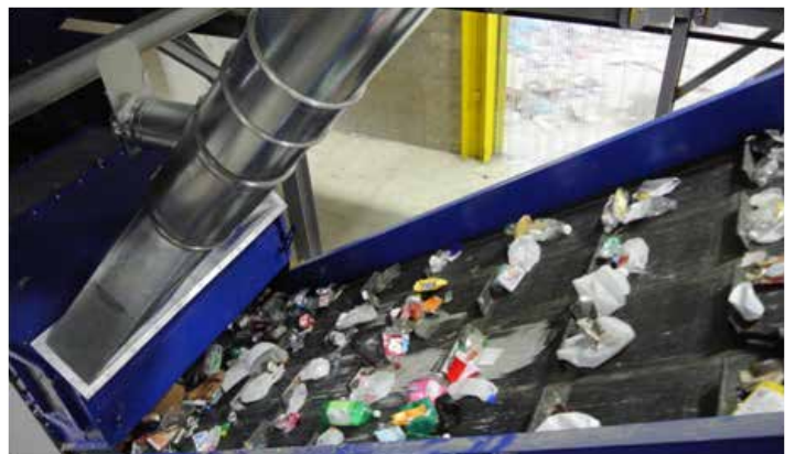
Plastik na wylocie z Air knife
